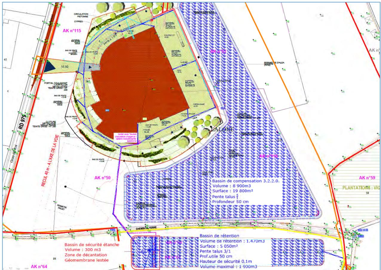
Figure 73: Plan de gestion des eaux pluviales et compensations
